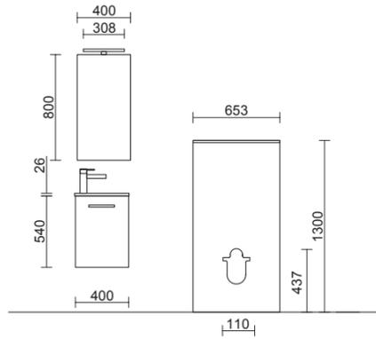
**MICRO.** Meuble lave-mains avec une porte à fermeture amortie et étagère intérieure ajustable en hauteur.
